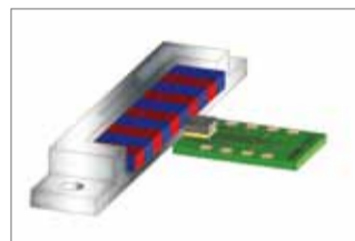
Bild 4: Das Bild zeigt den prinzipiellen Aufbau der Messanordnung. Der AMR-Sensor ist hier auf einer Platine montiert und tastet das magnetische Wechselfeld des Maßstabs ab (Quelle: Sensitec GmbH).
