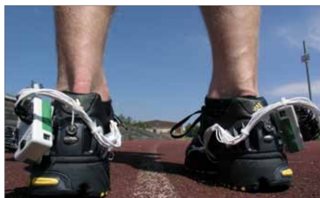
Bild 1: Messsystem mit Datenlogger zur Funktionsanalyse eines Laufschuhs (Quelle: FH Kaiserslautern)
