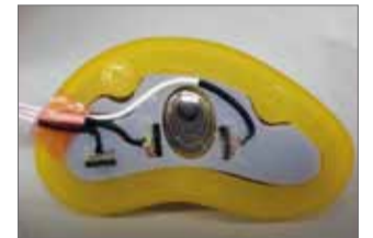
Bild 5: Links: Obere Gleitplatte mit Magnetstreifen; mittig: untere Gleitplatte mit gefrästen Aufnahmen für die AMR-Sensoren; rechts: zusammengebaute Ferseneinheit mit Sensoren für den Einbau in den Schuh (Blick von unten) (Quelle: FH Kaiserslautern)
