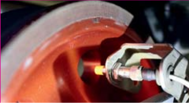
Ein induktiver Sensor an einem Rad der Blue Fire ermittelt die genaue Position auf der Bahn
